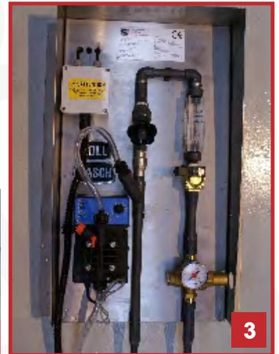
Alcuni esempi: 1. Estrattore magnetico con demagnetizzatore tipo ESMA-D-330 di fronte a una copertura insonorizzante AFOCOP-FX-D-330 su macchina Orbital RWO-D-330; 2. come foto precedente ma con copertura aperta e estrattore magnetico in posizione rialzata; 3. Stazione di dosaggio automatica per miscelazione acqua e composto chimico liquido DOS-KEM-150; 4. Rialzo per macchine circolari FRIBO; 5. Vasca inox per risciacquo ad immersione, completa di nastro trasportatore, serie UNIVAR-PVC.
