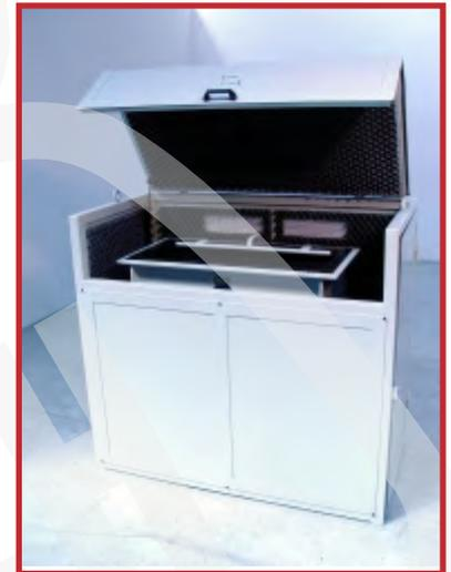
Tutte le macchine della serie Special con sezione della vasca ad "U" possono adottare paratie atte alla compartimentazione della vasca, ove fosse eventualmente richiesto. Grazie alle cabine serie AFOCOP-BOX si possono contenere agevolmente i livelli di rumorosità. Tutte le macchine serie Special e anche RWP-S sono progettate per supportare elevati carichi e operare ad alta frequenza (3.000 rpm).
