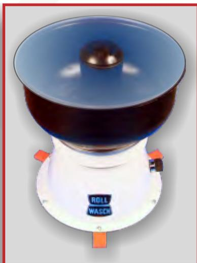
Una serie di macchine a vibrazione professionali, con un motovibratore monoblocco in alluminio regolabile in ampiezza, una vasca in poliuretano come le macchine industriali, un design robusto. Pratica e funzionale, Minor-XS può lavorare sia a secco che a umido, grazie a un filtro di drenaggio asportabile, sostituibile con un tappo in poliuretano. ideale per la finitura di piccoli articoli, per piccoli batch, laboratori, hobby.
