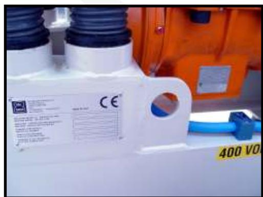
**PIONEER** - la serie Pioneer è caratterizzata da un design essenziale ma molto attento ai fattori di sicurezza, come i punti di sollevamento e il fissaggio del cavo motore entro la sagoma del telaio.
