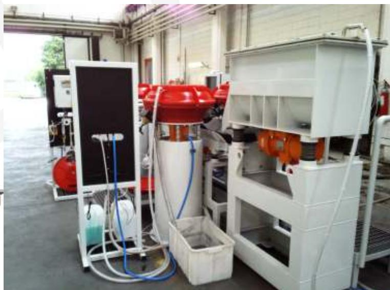
Un esempio di soluzione impiantistica RW-1776 per la vibrofinitura di articoli in acciaio temperato dove è prevista una macchina modello Pioneer RWP-L-150, in esecuzione speciale con telaio rialzato.
