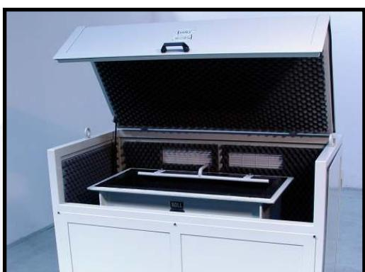
**AFOCOP-BOX** - Le cabine per l'attenuazione del rumore, oltre all'apertura superiore hanno anche un'apertura in corrispondenza della portella di scarico laterale.
