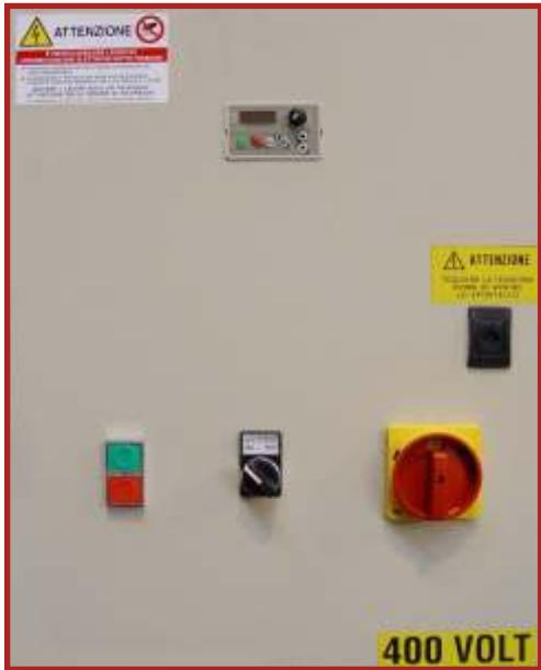
Vista frontale del nuovo quadro comandi serie MPA, nella versione 400 V - 50 Hz - trifase. Versione base dotata di variatore di frequenza e arresto di sicurezza, con raffreddamento automatico temporizzato del gruppo di riscaldamento. Frontal view of the new control board of the MPA series, 400V - 50Hz version - three-phase. Basic solution including frequency converter, with automatic cooling after programmed time of the heating group.
